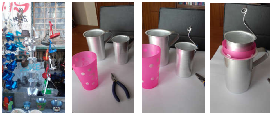
Απλή κατασκευή φιάλης leyden με κανατάκια κρασιού
