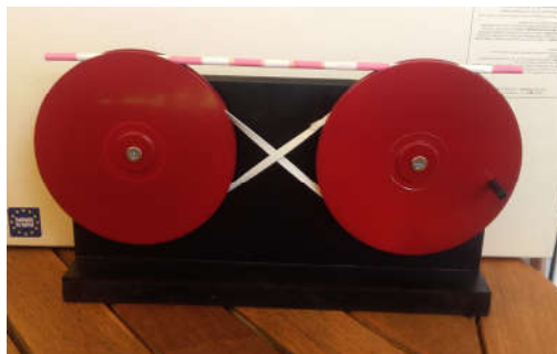
Εικόνα 2: Η χειροκίνητη συσκευή ταλάντωσης ράβδου πάνω σε περιστρεφόμενους δίσκους
