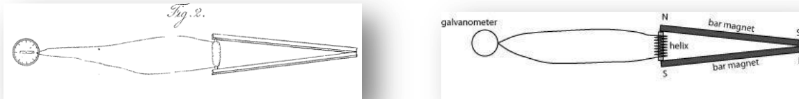
Εικόνα 35. Αριστερά : Αρχικό σχέδιο του Faraday από το Experimental Researches in Electricity (1832). Δεξιά : σύγχρονο επεξηγηματικό σχέδιο.
