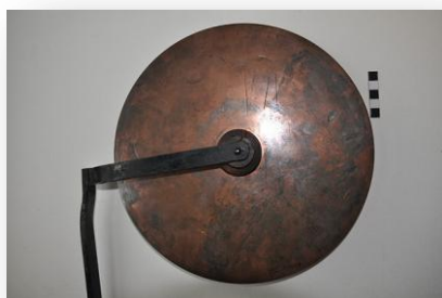
Εικόνα 41. Αριστερά: Ο αυθεντικός δίσκος που χρησιμοποίησε ο Faraday (μουσείο Faraday, Royal Institute) Δεξιά: Επεξηγηματικό σχέδιο των επαφών, του μαγνητικού πεδίου και του τρόπου περιστροφής
