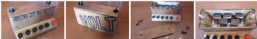
Εικόνα 52. Πολλαπλή μπαταρία 9...45 Volt
