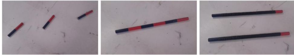
Εικόνα 62. Τρόπος κατασκευής μακρόστενου μαγνήτη από τρεις μικρότερους
