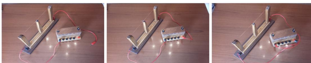
Εικόνα 55. Εκτροπή της βελόνας στο πείραμα του Ørsted. Ορθή (2η φωτό) και ανάστροφη (3η φωτό) εκτροπή, ανάλογα με τη φορά του ρεύματος
